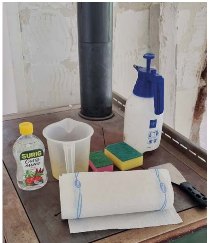
Abbildung 20: Essigessenz ist ideal auf glatten, nicht-mineralischen Oberflächen
