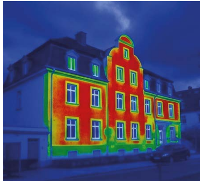
Abbildung 09: Aufnahme der Wandoberfläche mit einer Wärmebildkamera
